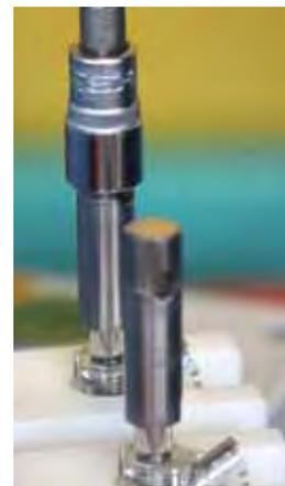
Bei den nextgen™ Verbindern nutzen wir reines Kupfer oder Feinsilber für den Signalleiter. Oben sehen Sie Fertigungsschritte der CE-konformen Bananenstecker mit Signalleitern aus Feinsilber. Der umschließende Körper besteht aus modernen Funktionswerkstoffen. Das ist für die Fertigung und die Haltbarkeit entscheidend.
