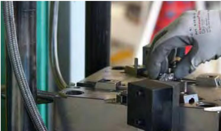
Hier wird gerade der Kunststoffkörper für den Bananenstecker WBT-0610 gefertigt. Im Bild ist nur eine der beiden Werkzeughälften zu sehen. Die Besonderheit besteht in dem Innengewinde des Kunststoffkörpers: Nach dem Umspritzen muss der Werkzeugkern, der das Gewinde formt, drehend durch zwei Hydraulikzylinder herausgeschraubt werden.
