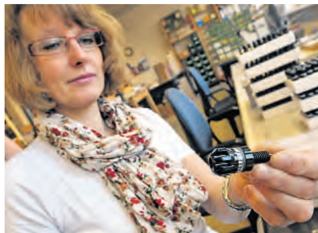
Gabi Kötter montiert Metallkontakte mit Spritzguss-Gehäusen. Sie gehören zur neuen Stecker-Generation. Fotos: Heinz-Werner Rieck
