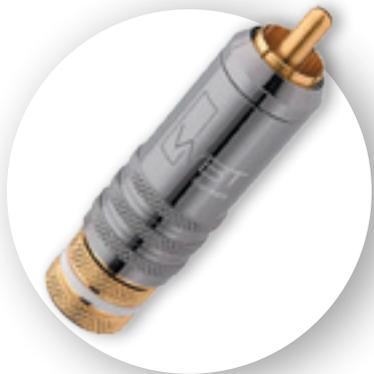
Ультратонкая обработка поверхностей обеспечивает бесперебойную работу устройства. Применен уникальный процесс покрытия с окончательным покрытием 24-каратным золотом. Запатентованная WBT™ баррель обеспечивает функции регулировки и блокировки. Ствол заключен в полированный титан. Изоляция выполнена из Teflon™. Максимальный диаметр кабеля — 9 кв. мм/0,354 кв. дюйма.
