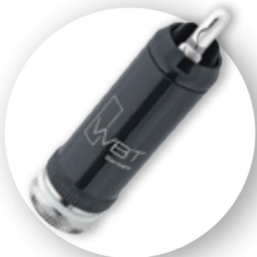
Использованы контакты из пассивированного чистого серебра. Корпус для хорошей эстетической привлекательности выполняется с латунным, а затем платиновым покрытием. Центральный контакт изготовлен из Ultramid®, отрицательный контакт — из Dyneon™. Волновое сопротивление 75 Ом делает этот разъем идеально подходящим для цифрового аудио и видео. Максимальный размер сигнального провода 1,5 кв. мм/16-17 AWG. Максимальный диаметр кабеля с диэлектриком — 9 кв. мм/0,354 кв. дюйма.
