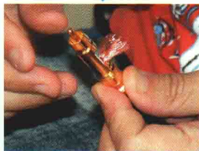
⑤プラグの取り付け ケーブルの先端にさす
