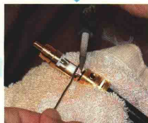
⑨ 編組のハンダ付け 編組に染み込ませるように行う
