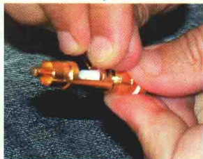
⑥プラグと編組の処理 編組の厚さを均等にする
