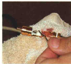
⑦ 中心導体のハンダ付け 素早く確実にを行う
