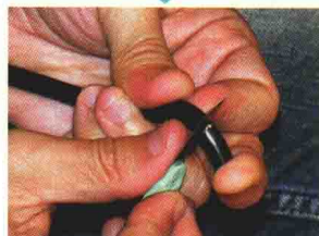
②被覆の処理 編組(外側の導体)を切らないように行う
