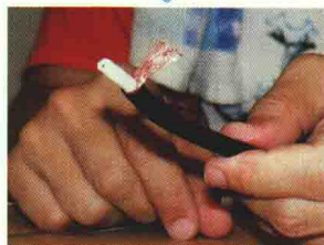
③編組の処理 ピンセットで一方方向に束ねる
