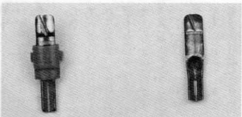
コールド側に接するプレート。従来型のプラグではホットピンの周りにリング状にあるものだ。これも高純度の銅製。斜めの筋が見えるだろうか。実際はこのラインで接触することになるという
